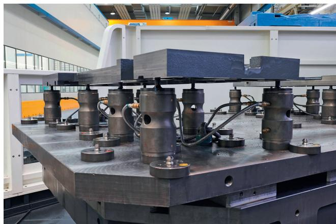
2 Auf Maschinenpaletten mit rüstzeitminimierenden Spannlösungen wird heute µ- und wiederholgenau mit drei Aufspannungen gefertigt, wo früher elf Mal gespannt wurde © AMF
